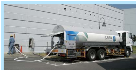
ヘリウムをマイナス196度まで冷やすために使われる液体窒素は、タンクローリーで運ばれてきます。
