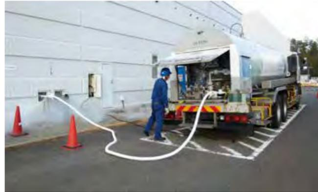
液体窒素をタンクローリーから実験室に移送している様子
